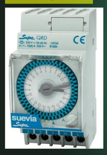
Timer berfungsi sebagai switch yang diatur oleh waktu. Sama seperti relay dan kontaktor, timer membutuhkan sumber tegangan untuk menjalankannya. Pada umumnya satu strip mewakili 30 menit atau 15 menit tergantung tipe timernya.
